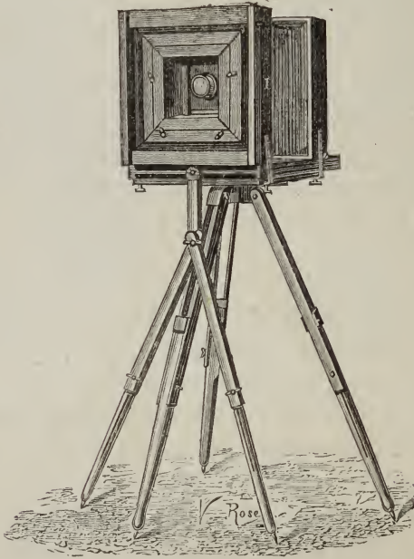
FIG. 15. — Chambre de voyage montée sur son pied, système français muni d'un pied en X.
